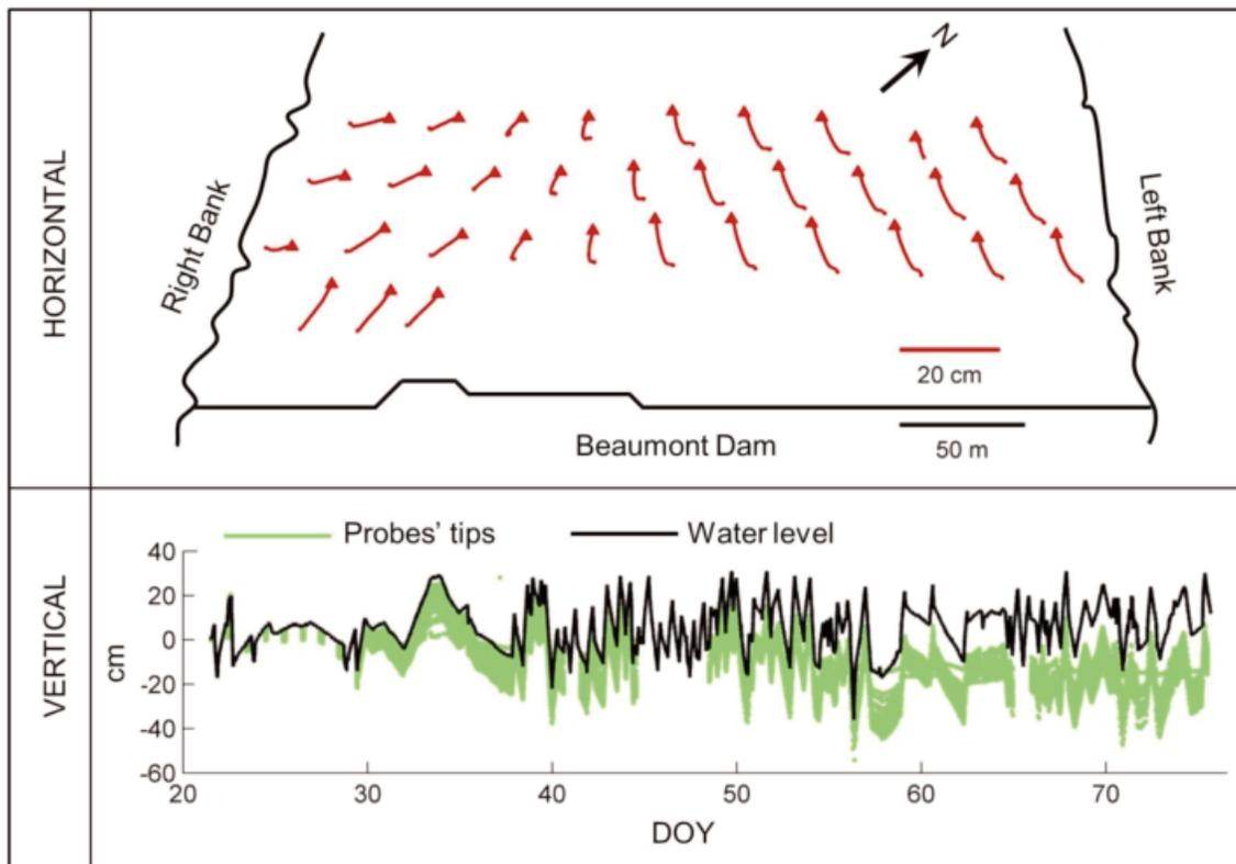
**Figure 1: Horizontal and vertical displacements of the probes' tips from January 21 to March 16, 2009 (adapted from Prat et al., 2012) / Déplacements horizontaux et verticaux de la pointe des pôles du 21 janvier au 16 mars 2009 (adaptée de Prat et al., 2012)**
