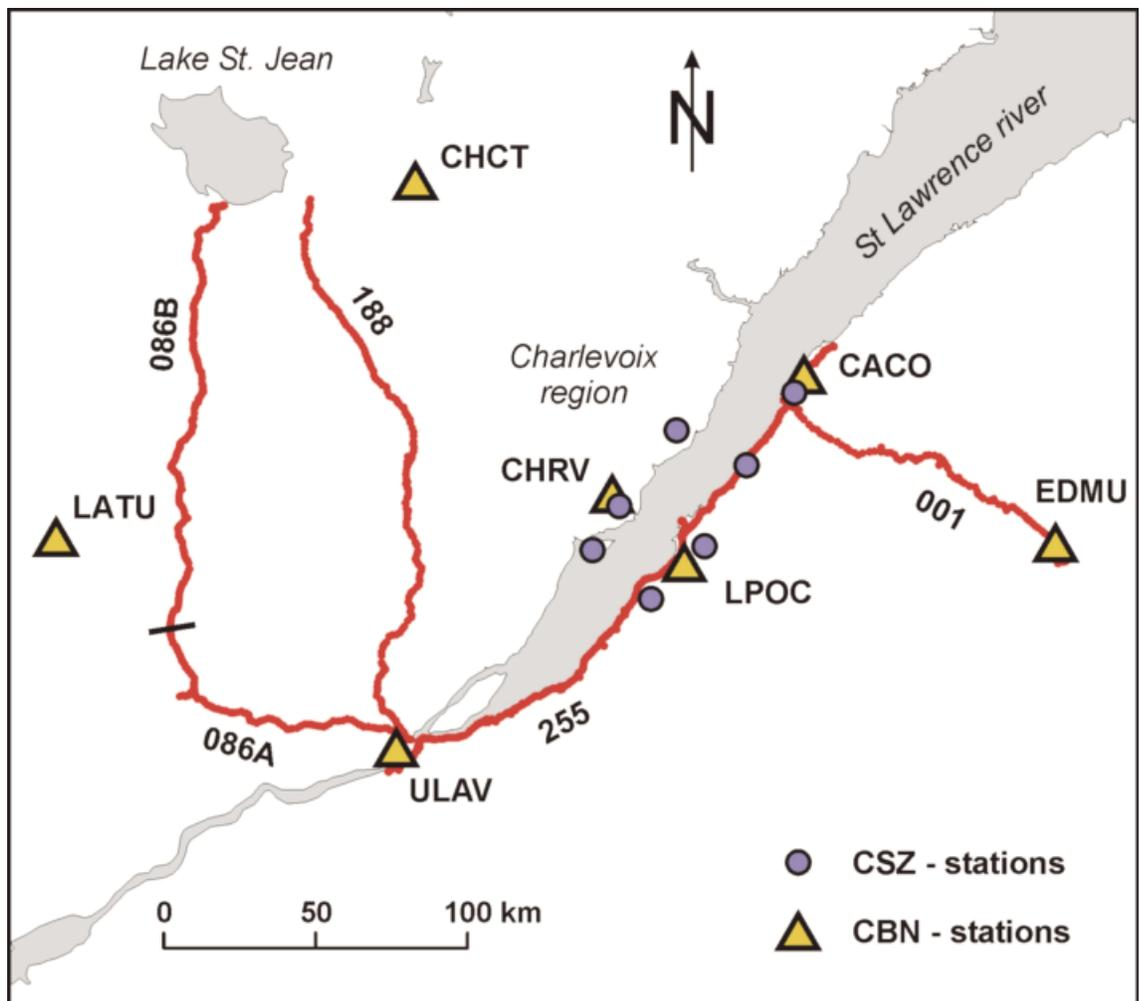
Figure 4: Global view of CSZ GPS campaign, levelling data and CBN stations / Vue d'ensemble de la campagne GPS dans la zone sismique de Charlevoix (CSZ), des mesures de nivellement et des stations du réseau de base canadien (CBN)
