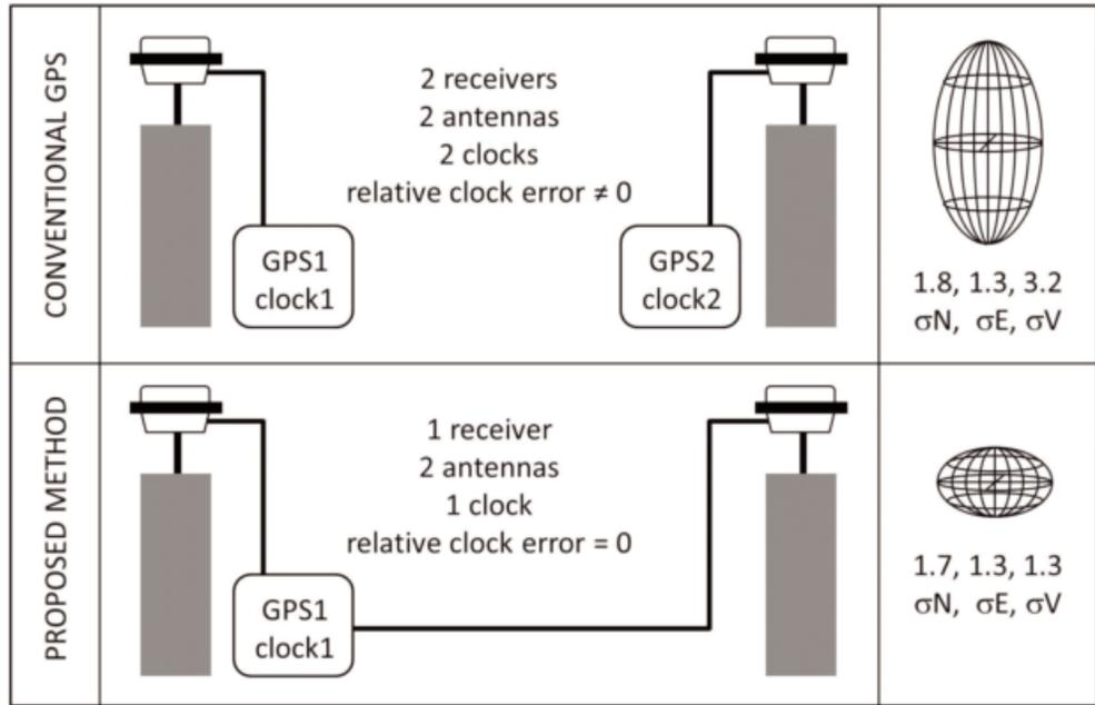
Figure 2: Comparison between conventional GPS and proposed method (adapted from *Santerre and Beutler, 1993*) / Comparaison entre le GPS conventionnel et la méthode proposée (adaptée de *Santerre et Beutler, 1993*)
