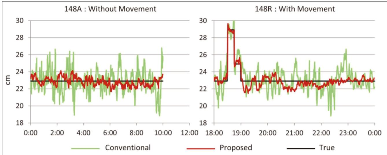
**Figure 3: Vertical component for conventional GPS compared with the proposed method (adapted from Macias-Valadez et al., 2011) / Composante verticale du positionnement GPS conventionnel comparée à la méthode proposée (adaptée de Macias-Valadez et al., 2011)**
